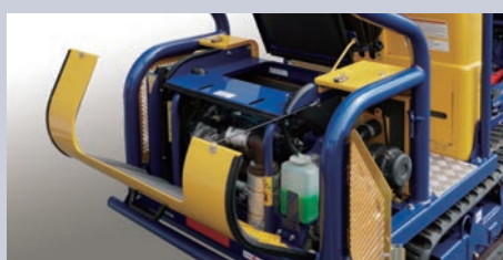
Brede deksler for enkel tilgang til E/G komponentene.
