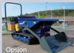
Auxilliary tredje funksjon for tilkobling av selvlastere etc.
