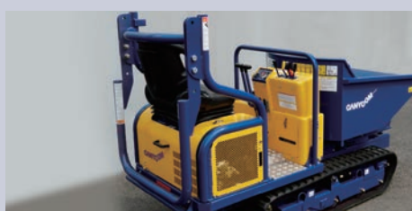
Nedfellbar ROPS bøyle for transport og arbeid på steder med lav høyde.
